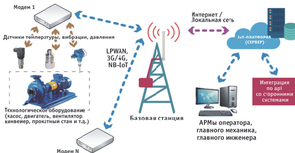
Рис. 3. Принцип работы технологии IIoT.Istok.SCADA (промышленного интернета вещей), разработанной АО «НПП «Исток» им. Шокина»
