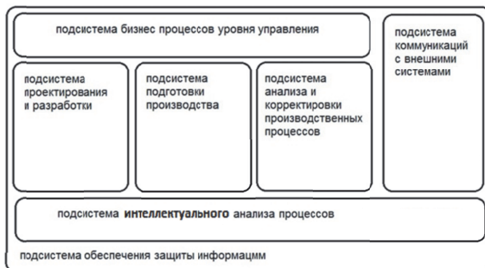
Рис. 4. Структура системы информационной поддержки процессов на примере машиностроительных предприятий
