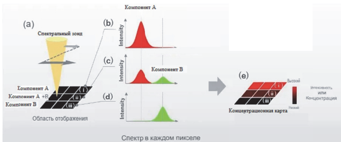
Рисунок 2 – Картирование образцов композита с использованием зондовой ИК-спектроскопии НПВО
