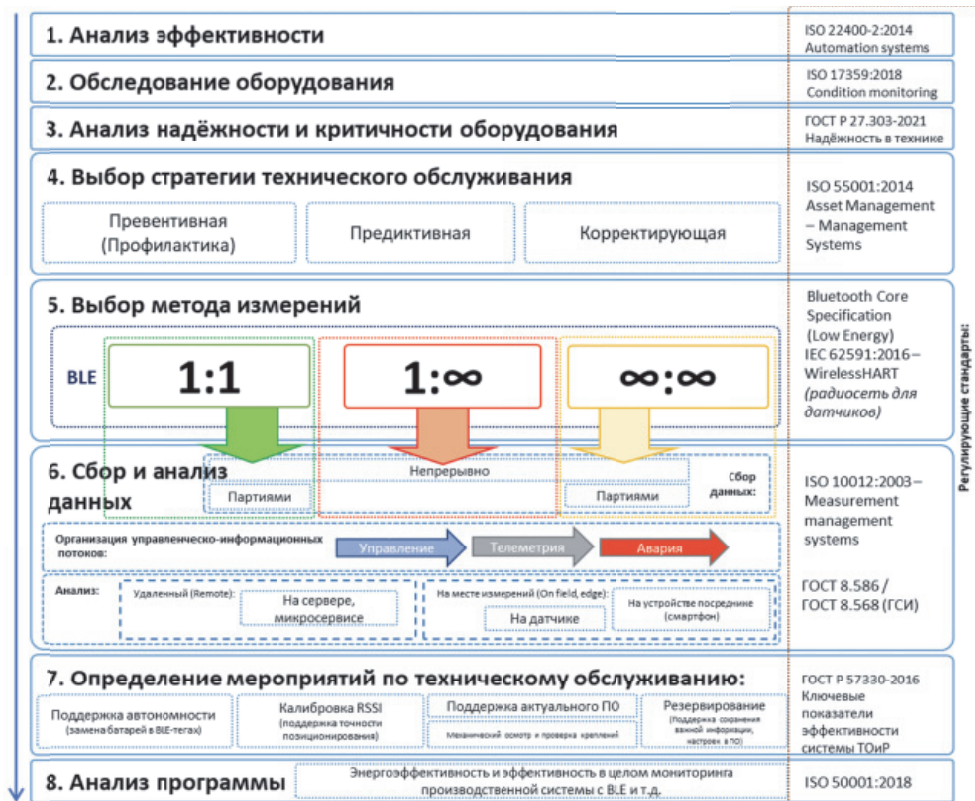
Рис. 7. Концептуальная модель организации мониторинга производственной системы с использованием протокола BLE и его трех основных типов
