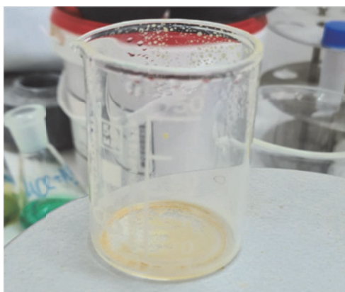
Рис. 1. Осадок, полученный после выпаривания полученного из колонки раствора при работе со смолой АВ-17 (14/32 \mu )
