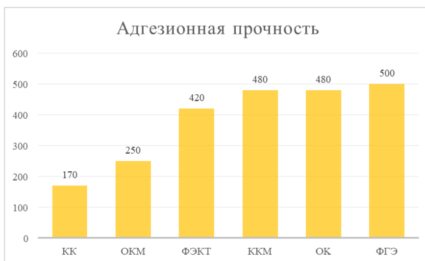
Рис. 2. Зависимость адгезионной прочности от состава клеевых растворов (Dependence of adhesive strength on the composition of adhesive solutions)
