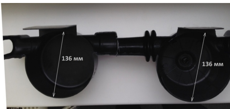
Рис. 3. Внутренние диаметры ПЗУ «Эко-НИОКР» (слева) и ПЗУ «Авис» (справа)
