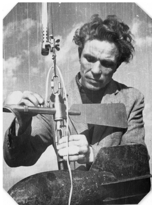
1961 г. Куйбышевское водохранилище. А.И. Елисеев готовит прибор для измерения скорости течения
